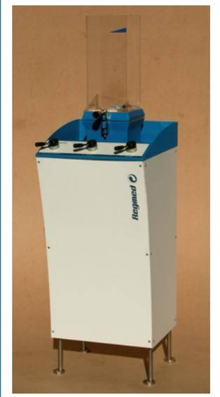
O FQ-21AA é um formador de folhas manual utilizado para a produção em laboratório de folhas quadradas destinadas aos ensaios físicos e ópticos de celulose.
