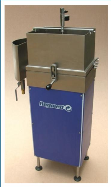
O SM-21 é um Depurador de fibras tipo Somerville. Este equipamento é utilizado mundialmente para separação das frações de contaminantes de suspensões celulósicas, tais como shives, stickies e partículas.
