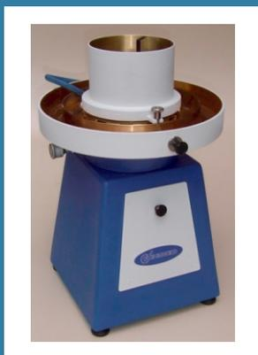
O equipamento Classificador de Fibras é utilizado na separação das frações de ciscos, fibras longas, fibras curtas, fibras destruídas e fibrilas de uma suspensão celulósica, permitindo ao usuário quantificar cada uma destas frações.
